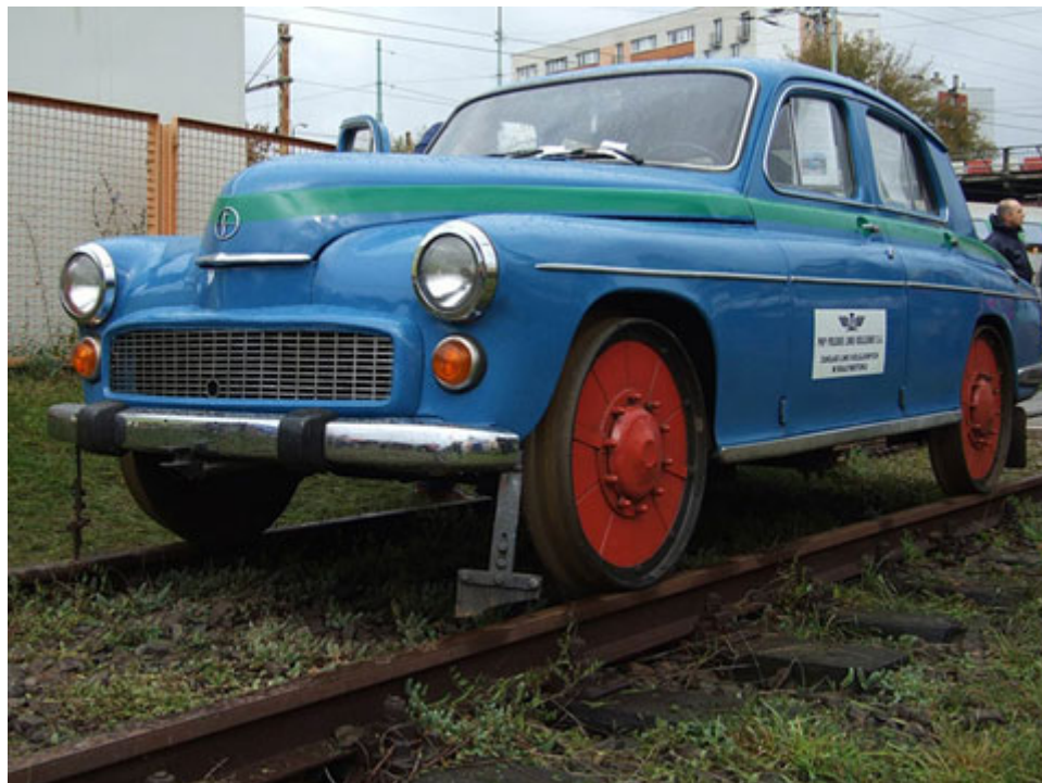
19. Tę Warszawę przerobiono na dreżynę. Umożliwiała szybki przejazd (do 100 km/h) po torach na wybrane miejsce, ale także jazdę po drogach bitych
