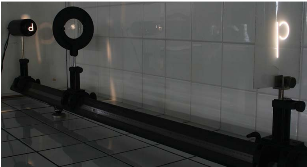
Fot. 4. Wygląd opisywanego wstępnego montażu: przedmiot – soczewka – ekran półprzezroczysty („matówka”) na ławie optycznej
