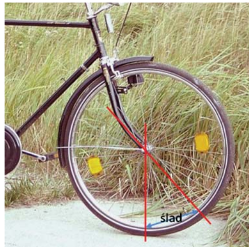
Rys. 4. Ślad w miejskim rowerze typu holenderka
